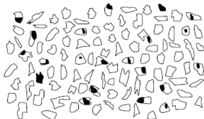
Bijih dengan derajat liberasi yang jelek, masih banyak emas (bagian hitam) yang terikat pada batuan induk.
